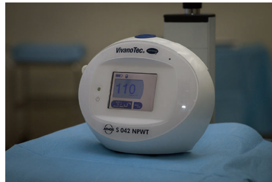
Рис. 20. Вакуумный аппарат системы отрицательного давления
