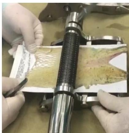
**Рис. 5. Пример работы перфоратора ПАДТ-2,0 на одном валу с пластиной**
