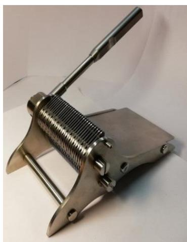
**Рис. 2. Перфоратор ПАДТ -1,0 на двух валах. Шаг перфорации 1:3**
